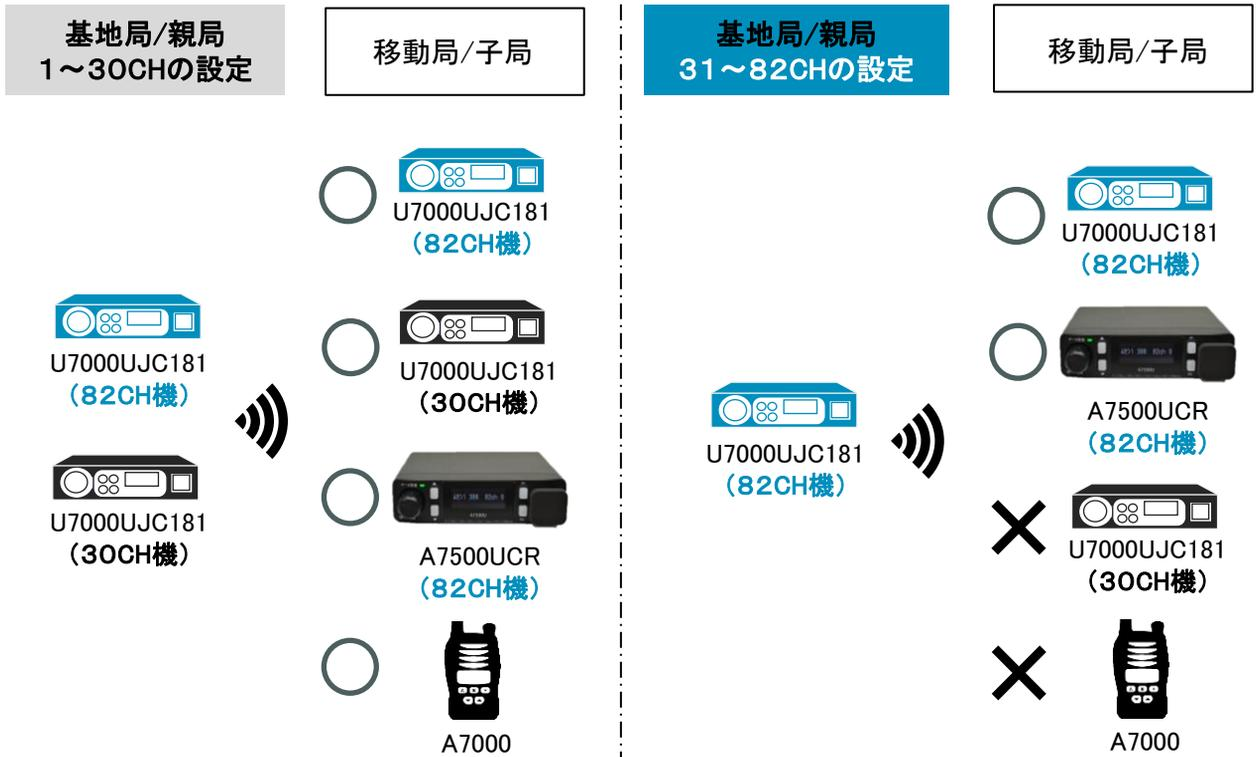
基地局/親局のチャンネル設定が1～30CH内であれば周波数が同じなので、82CH機と30CH機混合で通信ができます。
